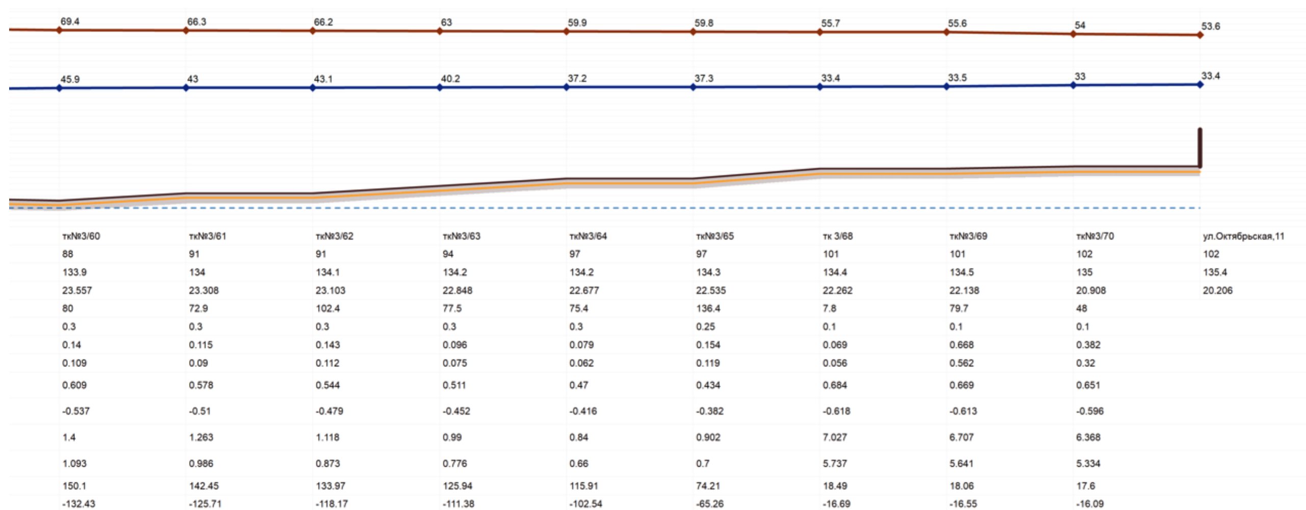
Рис. 3.4 - Пьезометрический график работы тепловых сетей ЗГРЭС I очередь
